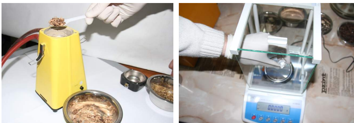
Figura 2. Aspecte din timpul cântăririi și concasării probelor în vederea determinării puterii calorifice și umidității
