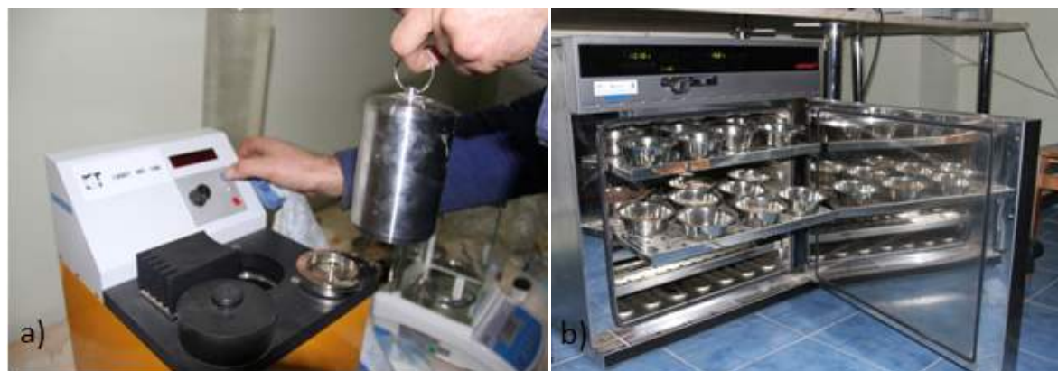
Figura 1. Aspecte din timpul determinării puterii calorimetrice la bomba calorimetrică LAGET MS – 10A (a) și a umidității în etuva de tip Memmert (b)
