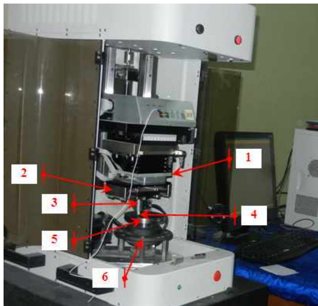
Figura 1. Tribotesterul universal UMT2 (CETR®, SUA), cu configurația PIN-la-disc:
