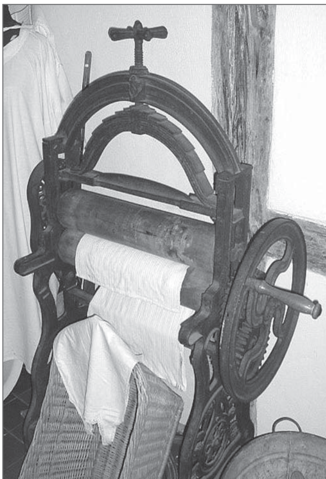
Fig. 6. Instalație de călcat cu două sucitoare prin care se trecea pânza umedă pentru a fi netezită. Instalație folosită pe larg la spălătorii în sec. XIX-XX 17 .
