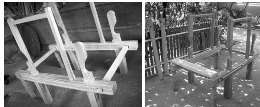
Fig. 3. Cadrul războiului de țesut: pat , chișioare , stinghii FOTO (etape ale procesului de elaborare)
