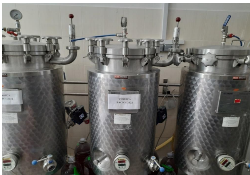
Figura 9.16 Vinificatoarele experimentale termostatate utilizate la fermentarea mustului din struguri Viorica .
