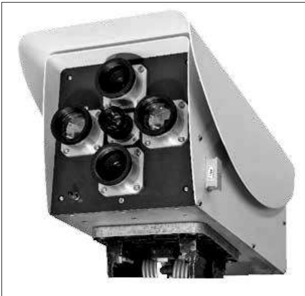
Fig. 8 Radiometru de teren cu patru canale spectrale
