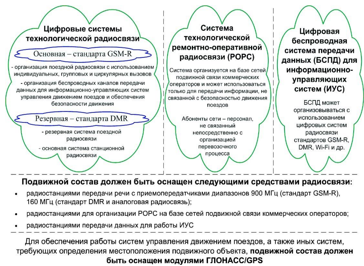
Рис. 1. Состав систем железнодорожной радиосвязи на GSM
