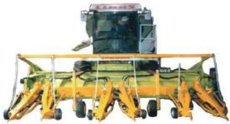
Echipament specializat de recoltat lavanda pe 3 rânduri.
