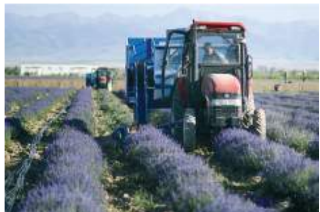
Echipament specializat de recoltat lavanda cu toba de tocare pentru 1 rând (CLIER-1) și 3 rânduri.
