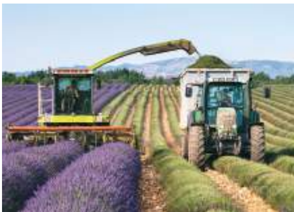
Echipament specializat de recoltat lavanda cu toba de tocare pentru 1 rând (CLIER-1) și 3 rânduri.
