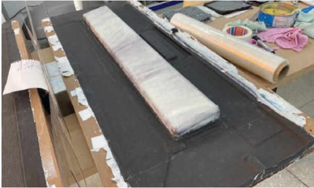
Fig. 4. O parte din modulul aripii centrale, după coacere.
