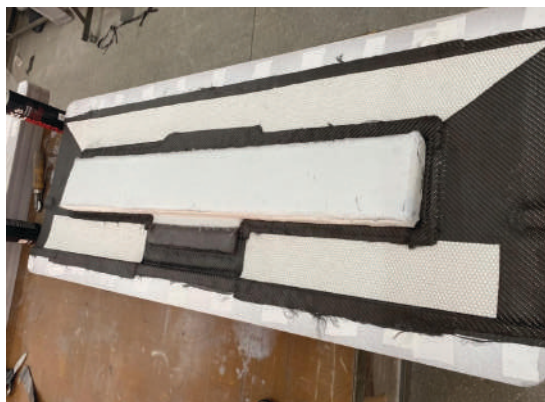
Fig. 3. Aranjarea țesăturii de carbon, fibră de sticlă, material poros în matriță.
