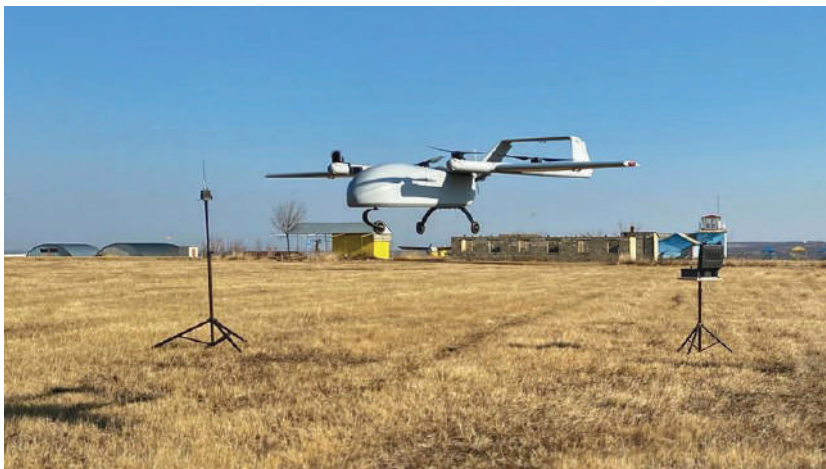
Fig. 7. Aeronava VTOL în planare, primul zbor de testare.
