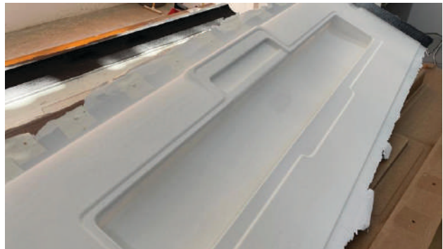
Fig. 4. O parte din modulul aripii centrale, după coacere.
