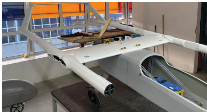
Fig. 7. Montarea preliminară a modulelor de bare VTOL pe cadrul aeronavei.
