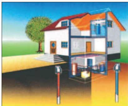
Fig. 1. Modelul clădirii încălzite cu pompă de căldură având ca sursă de căldură apa
