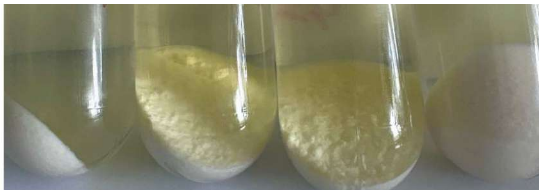
Figura 3. Aspectul probelor după centrifugare în sistemul lapte–chitosan
