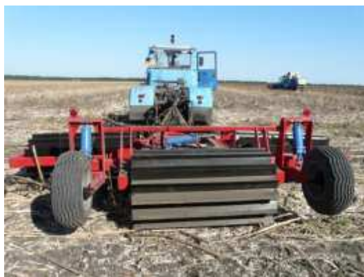
Рис. 3. Каток-измельчитель во время полевых испытаний [2]
