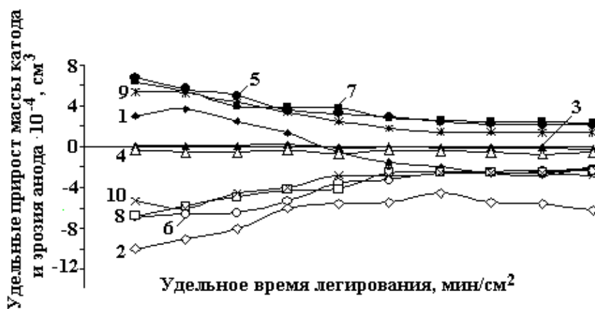
Рис.1. Удельные изменения масс катодов из стали 45 и масс анодов при ЭИЛ переходными металлами: а – IV группы, 1 – Ti^* , 2 – Ti -анод; 3 – Hf^* ; 4 – Hf -анод; 5 – Zr ; 6 – Zr -анод; б – V группы, 1 – V^* ; 2 – V -анод; 3 – Nb^* ; 4 – Nb -анод; 5 – Ta^* ; 6 – Ta -анод; в – VI и VIII групп, 1 – Mo^* ; 2 – Mo -анод; 3 – W^* ; 4 – W -анод; 5 – Cr^* ; 6 – Cr -анод; 7 – Ni^* ; 8 – Ni -анод; 9 – Co^* ; 10 – Co -анод
