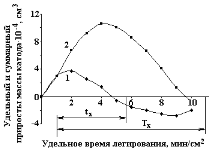
Рис. 2. Зависимость удельного и суммарного приростов массы и катода от удельного времени легирования при ЭИЛ стали 45 молибденом. 1 – удельный прирост массы катода; 2 – суммарный прирост массы катода
