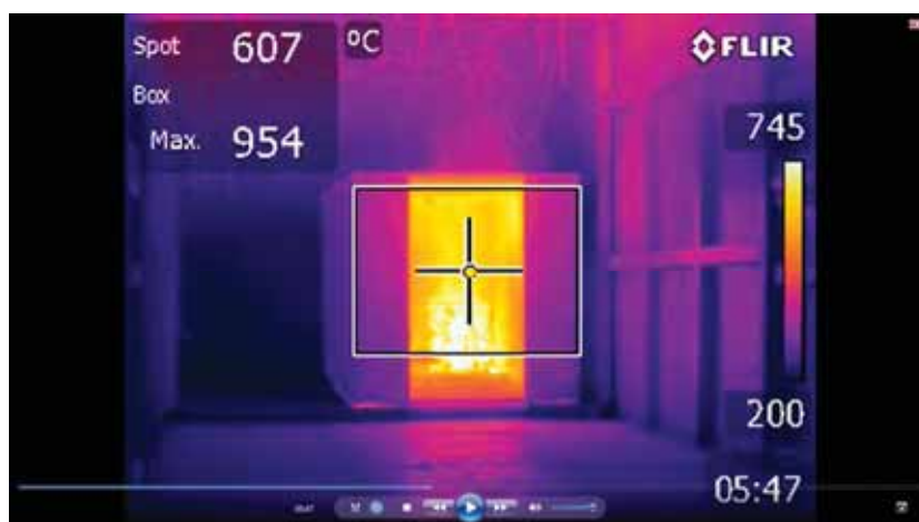
Figura nr. 10 - Atingerea temperaturii maxime în interiorul izolat al machetei incendiate.
