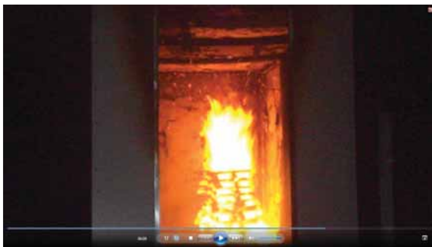
Figura nr. 11 - Desprinderea totală și distrugerea prin ardere a materialului izolant.
